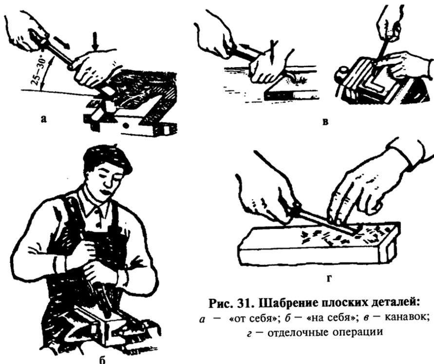
**Рис. 31. Шабрение плоских деталей:**
