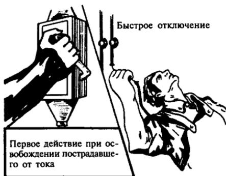
**Рис. 219. Освобождение пострадавшего от действия тока путем отключения электроустановки**
