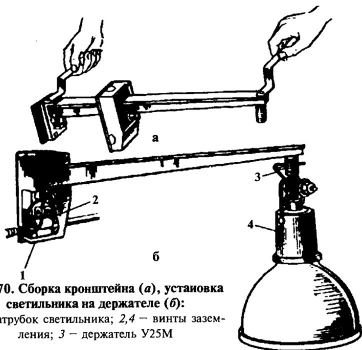
**Рис. 70. Сборка кронштейна (а), установка светильника на держателе (б):**
